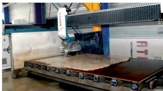
◀▲ Prévue lors de la construction, l'installation d'un second centre de façonnage n'a pas nécessité de travaux de génie civil particulier ni d'agrandissement de l'atelier. Le T 818 a été positionné aux côtés de la débiteuse numérique. Ces deux machines étant alimentées par la même potence.
